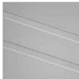
frezowanie na powierzchni skrzydła szerokość 15 mm we wzorach B10-B12
