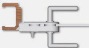
rys. 1. drzwi prawe / blokada na zewnątrz
