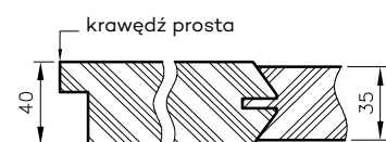
Przekrój poziomy drzwi Elsa
