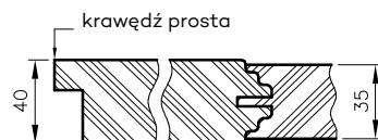
Przekrój poziomy drzwi Nestor
